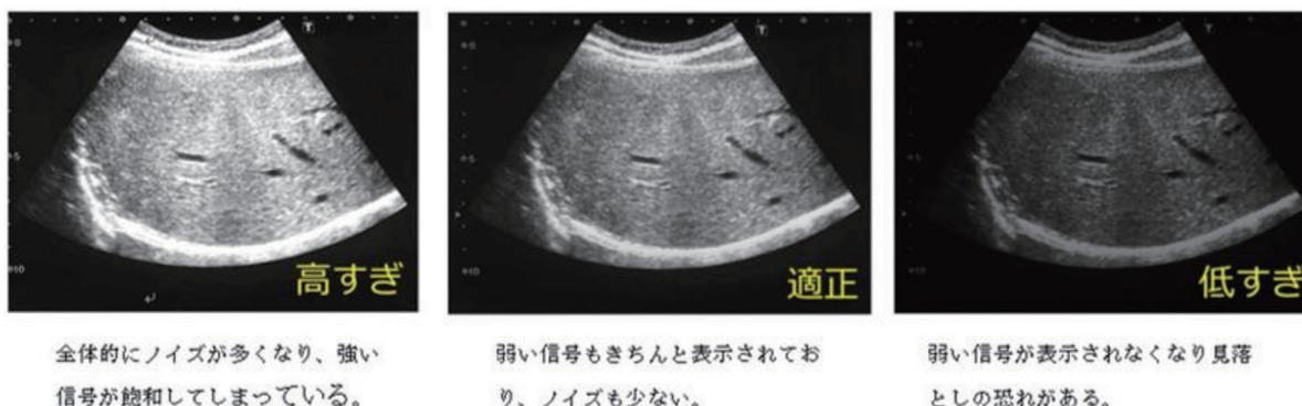
図2 画像全体の明るさの変化(ゲイン)調整
