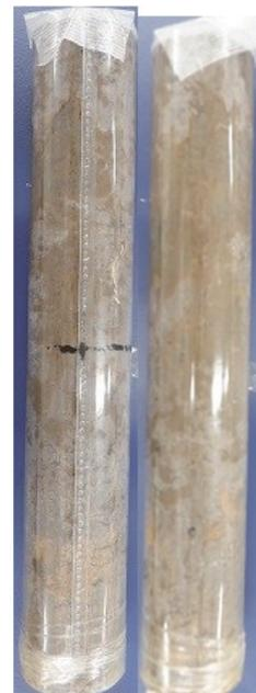
図11 ふた付きサンプルライナーチューブ1の写真 右側の写真は左側の反対から撮影したもの
