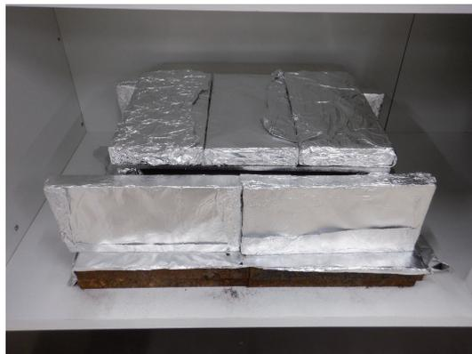
図1 ベクレル同好会が構築した陸奥鉄を用いた放射線シールド
